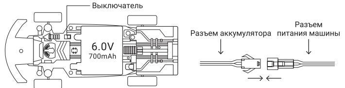
Откройте крышку батарейного отсека на машине. Установите аккумулятор в корпус машины. Проверьте, что выключатель питания на машине находится в положении OFF.
